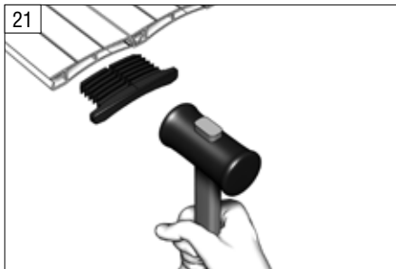
Установите боковые замки в ламели (тип замка SLE45, SLE55).
