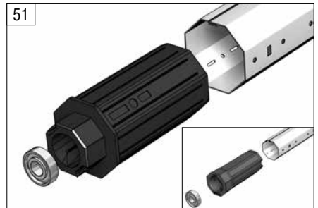
51 Установите с противоположной стороны вала капсулу универсальную с подшипником.
